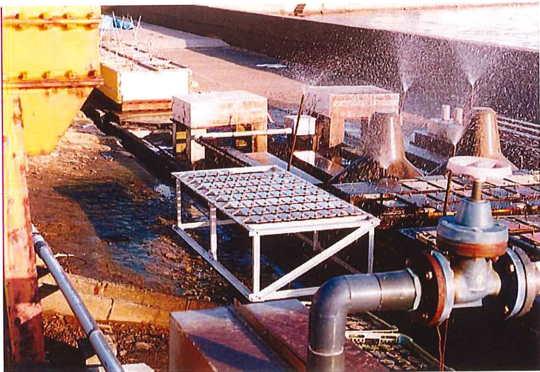
写真1. 海水シャワー暴露試験の状況
